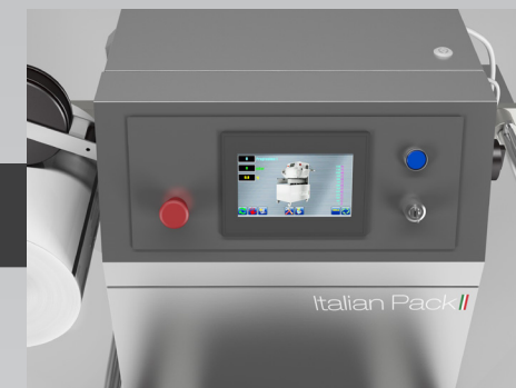
Plc Touch wide screen 7.2" a 6500 colori, porte USB/ethernet, 99 programmi, personalizzazione della lingua, controllo temperatura integrato, gestione avanzata parametri MAP, SKIN e graduate vacuum.
