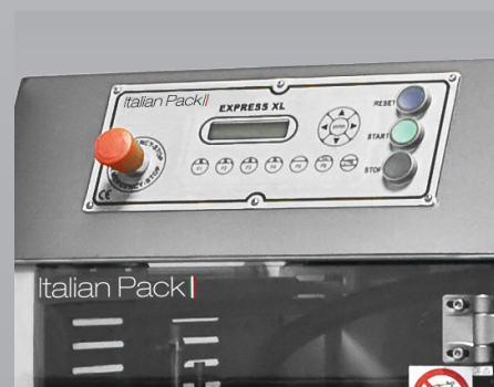
Scheda elettronica di nuova generazione con 10 programmi, personalizzazione della lingua, controllo temperatura integrato, gestione avanzata parametri MAP, Graduate vacuum e solo saldatura. State-of-the-art electric board with up to 10 packaging programs, language selection, integrated temperature control, menu-driven M.A.P. parameters, gradual vacuum and film sealing only.
