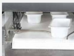
Nastro di scarico motorizzato con convogliatori per etichettatura.
