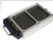
La macchina offre, standard, il cambio stampo rapido senza l'impiego di utensili, che semplifica le operazioni di sanificazione.
