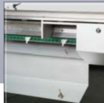
Cinta de alimentación con puertas abatibles y cadena lateral Infeed conveyor with side hinged panels & side mounted chain Conveyeur d'alimentation avec portes rabattables et chaîne laterale
