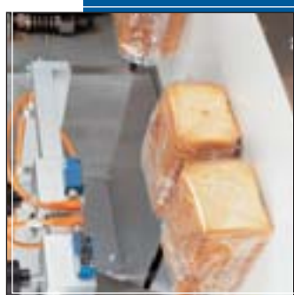
Conjunto expulsor de bolsas vacías y/o dobles Device for detection and reject of empty an/for double packs Dispositif de détection et rejet de sachets vides et/ou doubles
