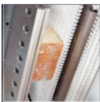
Cinta de arrastre motorizada en soldador - cortador Motorized conveyor in the transversal sealing-cutting group Convoyeur d'alimentation dans le groupe coupeur-soudeur
