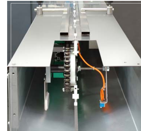
Cinta de alimentación con cadena desplazada Infeed conveyor with sided chain Convoyeur d'alimentation avec chaîne rapportée
