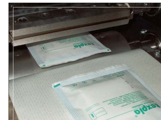
Grupo de soldadura y corte transversal
