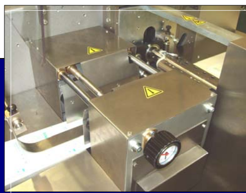
Grupo Soldaduras Longitudinales
